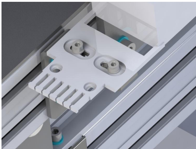
Рис.9 Фиксация кабель-канала на сдвижной платформе. Порядок загрузки БУРов в климатический стенд:
