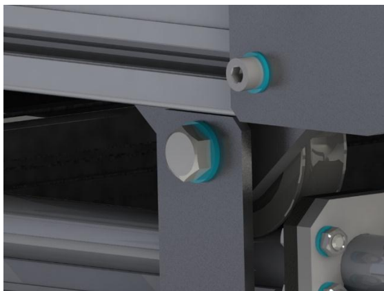
Рис. 7 Фиксация роликов болтом.
